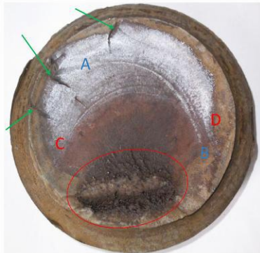
Foto nr.6 – suprafața de rupere ce aparține obturatorului spre zona de calare
