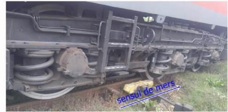
Fig. 6-poziția roților din partea dreaptă ale ultimului boghiu al locomotivei după oprire
