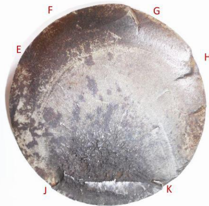
Foto nr.7 – suprafața de rupere ce aparține obturatorului spre fusul osiei
