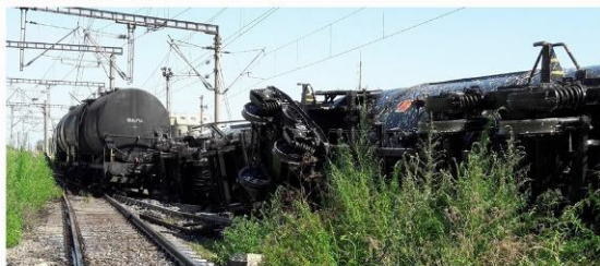
Foto nr.1 – poziționarea vagoanelor răsturnate
