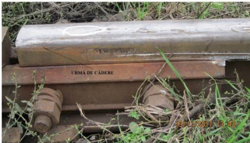
Fig.4-urmă de frecare pe flancul activ al șinei specifice căderii roții între firele căii;
