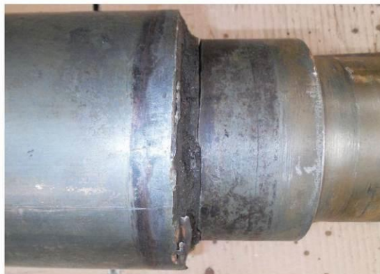
Foto nr.5 – detaliu zona unde s-a produs ruperea fusului de osie nr.3
